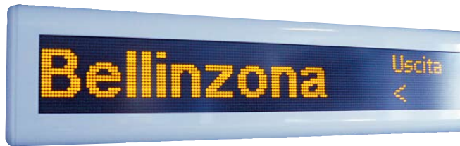
Bild 2: Die Top-LED-Innenanzeige für die dynamische Fahrgastinformation von Ruf Telematik, gefertigt bei BuS in Riesa
